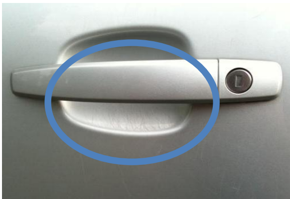
leichte Kratzbeschädigung im Bereich Türgriff
