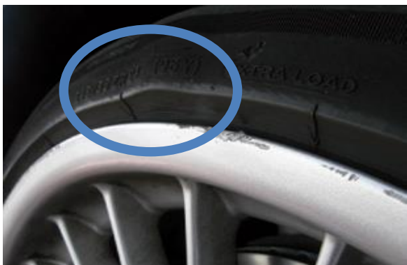
Verformung der Reifenflanke
