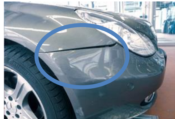
Spaltmaß außerhalb der Toleranz - Montagefehler
