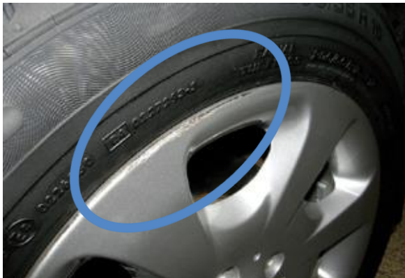
Über das Felgenhorn verteilte Kratzbeschädigung
