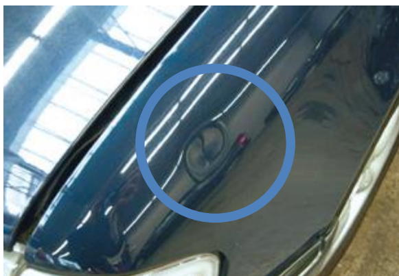
Tiefe Delle im Kotflügel > 2-Euro-Stück
