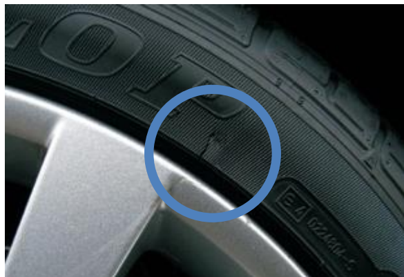
Einschnitt an der Reifenflanke
