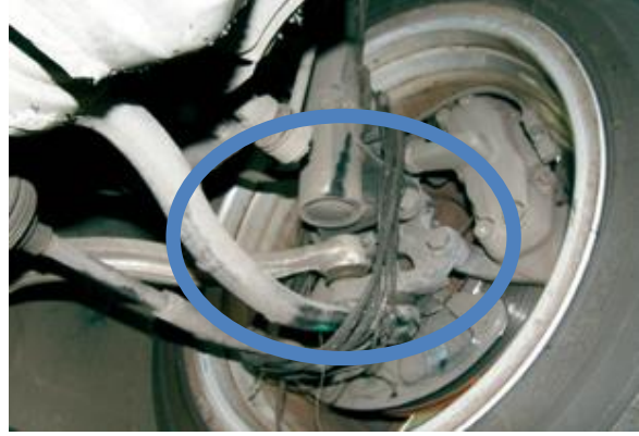
Nicht vollständig beseitigte Reparaturspuren (nach Reifenplatzer)
