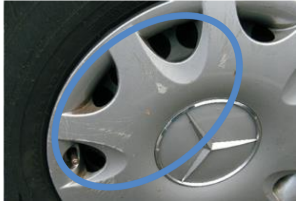
Stark kratzbeschädigte Radzierblende
