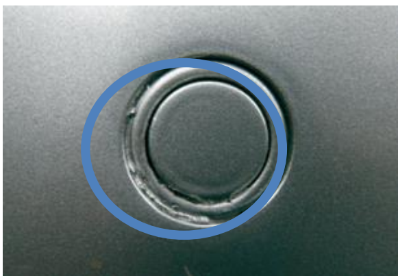
Einlackierungen aufgrund nicht durchgeführter Demontagearbeiten (hier einlackierter Einpark-sensor)
