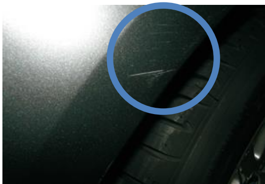
Kratzbeschädigung bis auf die Grundierung
