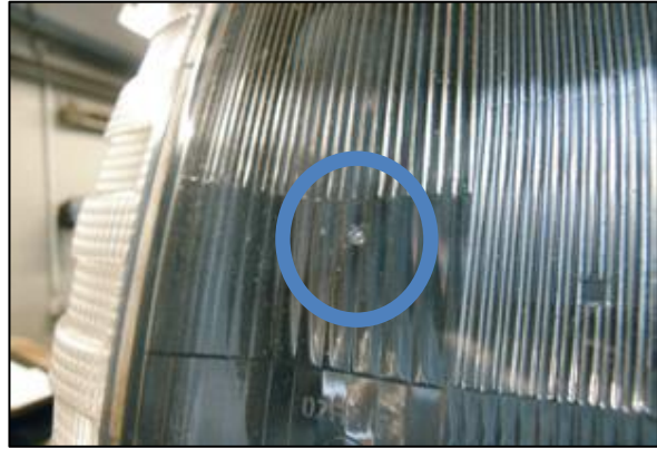
Steinschlag am Frontscheinwerferglas (Halogen)
