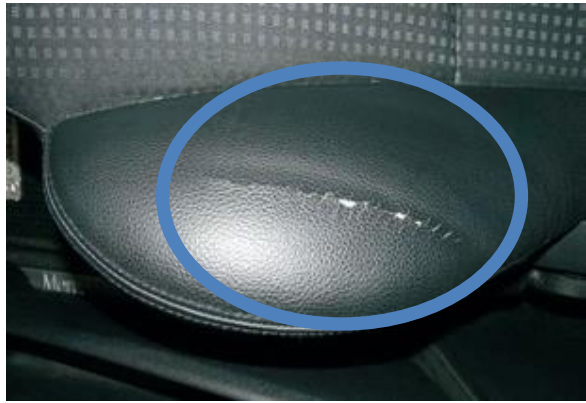
Riss in der Polsterung
