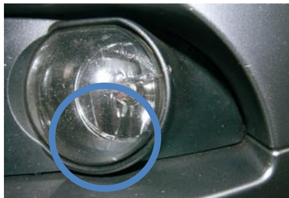
Lackanhaftung auf dem Nebelscheinwerfer
