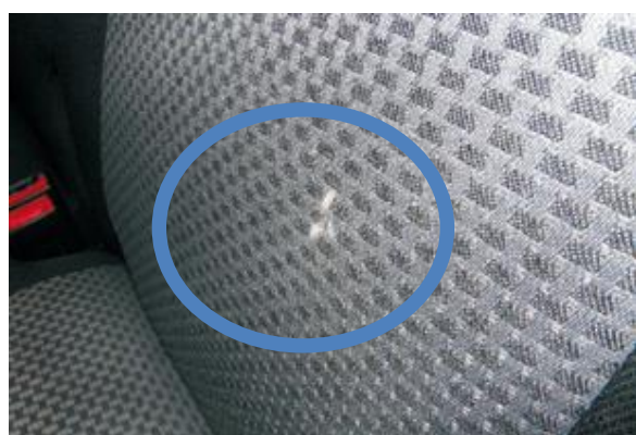
Beschädigung am Sitzpolster
