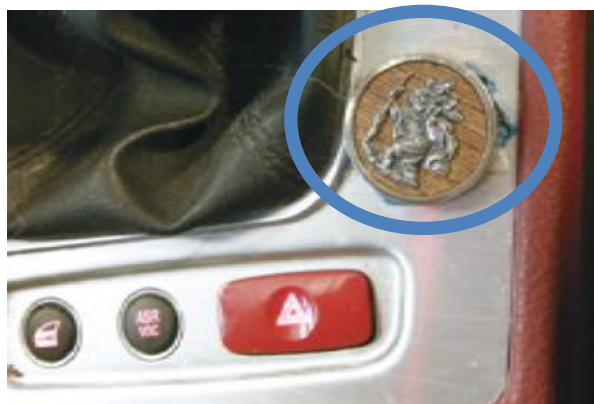
Beschädigung durch nicht rückstandslos entfernbares individuelles Zubehör/Einbauten
