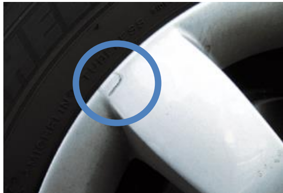
Bruchstelle an der Speiche
