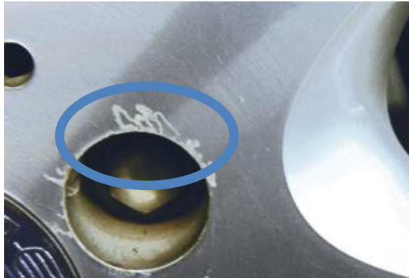
Leichte Beschädigung bzw. Korrosion
