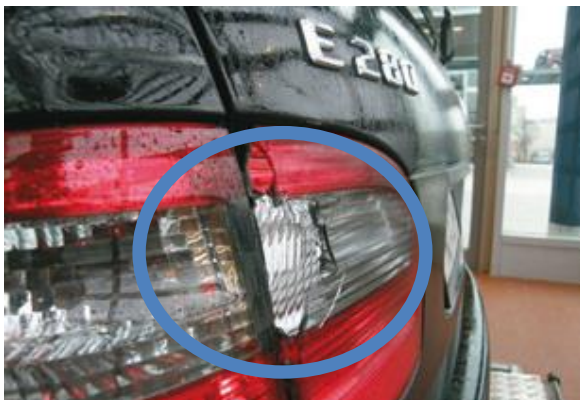
Beleuchtungseinheit und Heckdeckel beschädigt
