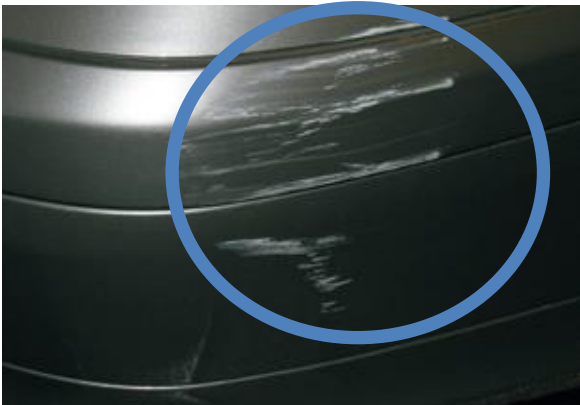
Kratzbeschädigung bis auf die Grundierung
