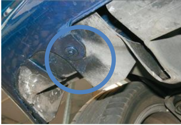
Lacknebel auf anliegenden Bauteilen
