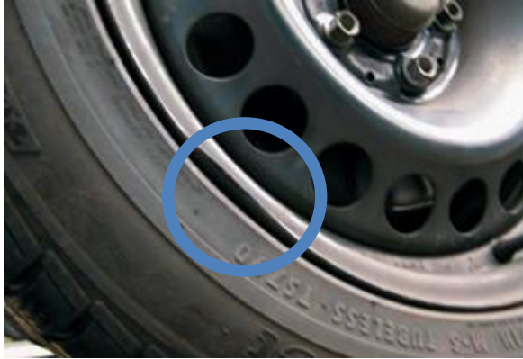
Deformation des Felgenhorns
