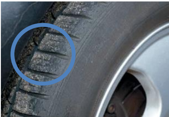
Reifenprofil im Toleranzbereich
