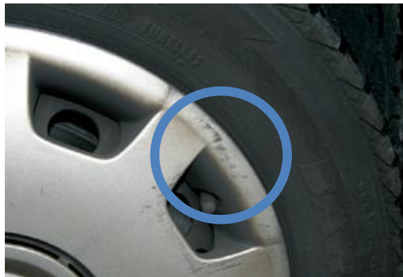
Leichte Kratzbeschädigung der Radzierblende
