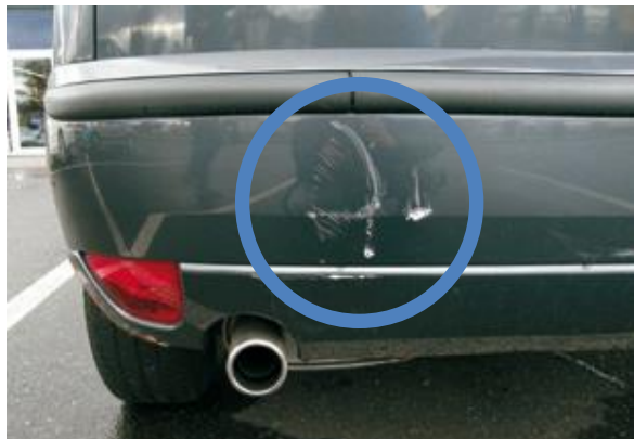
Kratzbeschädigung bis auf die Grundierung
