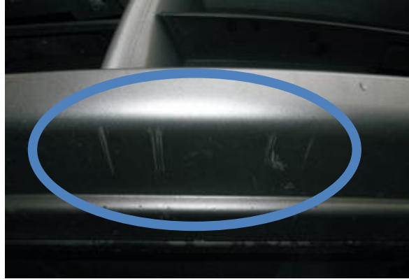
Kratzbeschädigung außerhalb des Sichtbereiches
