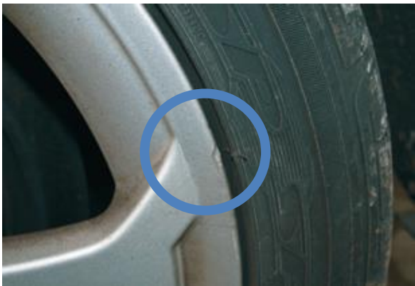
Leichte Kratzbeschädigung am Felgenhorn
