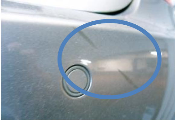
Schleifspur/Abrieb auf dem Decklack
